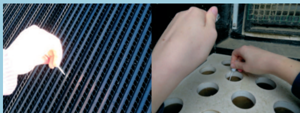
■ Figure 12 — Prélèvement avec écouvillon sur la face d'air neuf réchauffé entrant dans le bâtiment, sur ERC à plaques ou à tubes.
