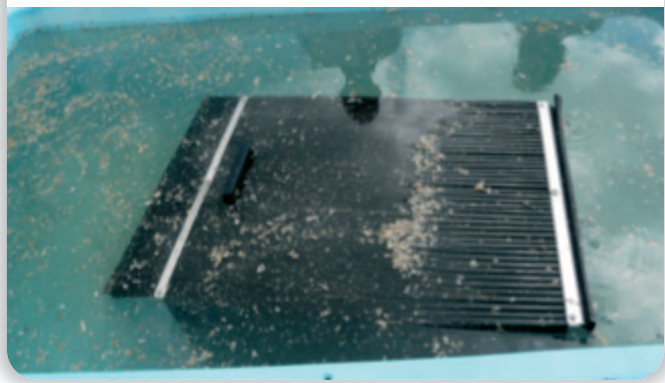
■ Figure 1 — Application de détergent par trempage du bloc amovible dans la solution.
